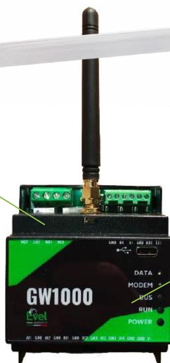
**GW1000** è il nuovo sistema di controllo dei sistemi di ventilazione EVEL, basato su trasmissione dati tramite cloud gateway (criptata) e su protocollo di comunicazione ModBus. Il controllo dei ventilatori e la manutenzione dei parametri viene gestita da remoto tramite qualsiasi device connesso ad internet (Wireless).
